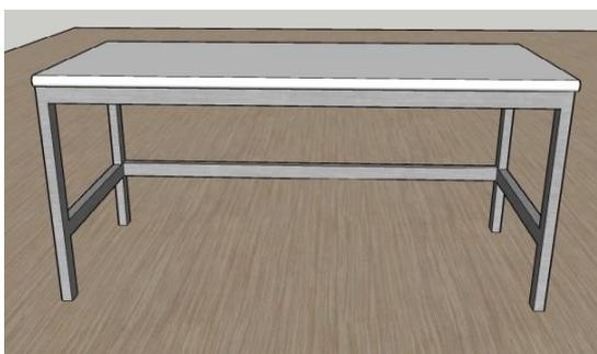
Algumas bancadas precisarão ser reforçadas nas estruturas (BM2), dependendo do peso do equipamento que ficará sobre a mesa (agitadores de plaquetas, centrífugas, etc), conforme imagem abaixo.
